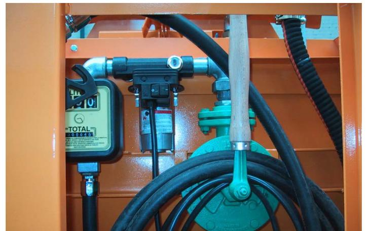
installation d'une pompe à main et d'une pompe électrique 12 ou 24 V
