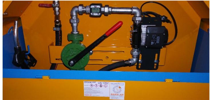
Compartiment des vannes avec pompe manuelle, pompe électrique et compteur
