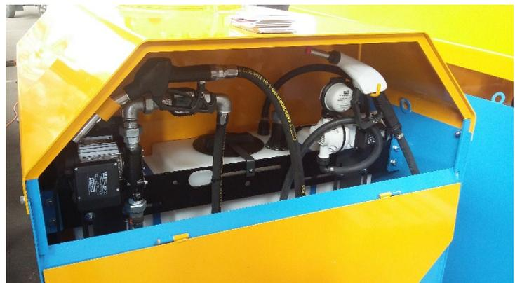
BT1750-1 / BT1000-2 avec réservoir Ad-Blue supplémentaire de 180 litres et accessoires de distribution
