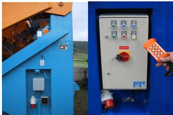
Opération manuelle (à gauche) ou manipulation par radio (à droite)
